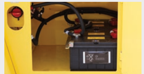
Compartimento de la batería con interruptor de desconexión de batería y cerradura
