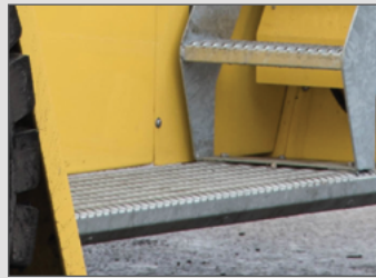
Estribos anchos y resistentes al deslizamiento
