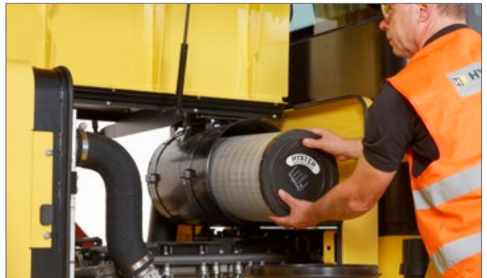
Las cubiertas en alas de gaviota proporcionan un fácil acceso para una rápida verificación del mantenimiento
