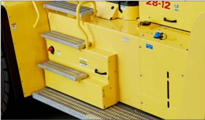
Estribos de longitud completa
