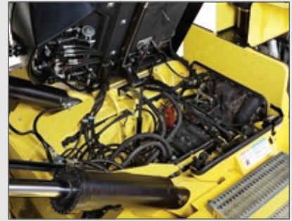
Sistema hidráulico a demanda
