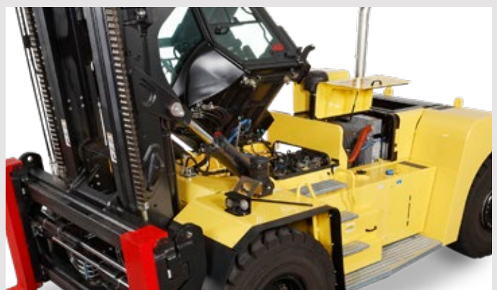
La inclinación motorizada opcional de la cabina permite un fácil acceso a los principales componentes hidráulicos
