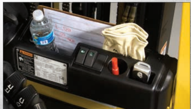
Estación de conveniencia del operador
