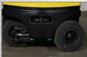
Eje de dirección de «giro cero»
