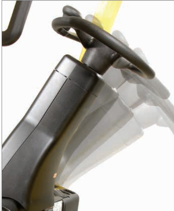
Columna de la dirección con inclinación infinitamente ajustable
