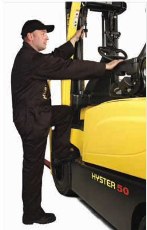
Entrada fácil con apoyo en tres puntos
