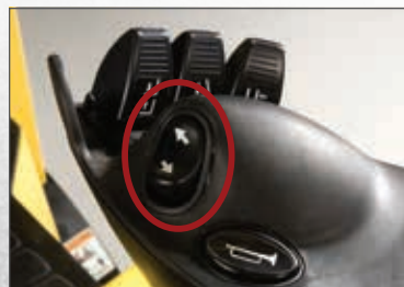
Controles direccionales al lado del asiento
