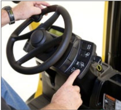
Columna de la dirección infinitamente ajustable
