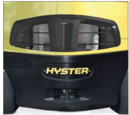
La ventilación de los contrapesos mejora el flujo de aire
