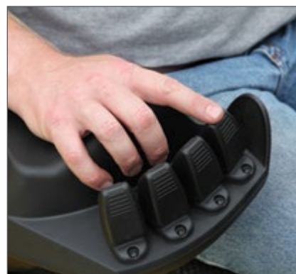
Controles electrohidráulicos de minipalanca TouchPoint
